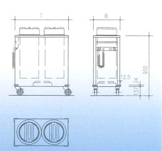
AUSFÜHRUNGSBESCHRIEB: Ganzer Wagen aus CNS 18/10 (Werkstoff 4301) doppelwandig isoliert. Stirnseitig Schiebegriff über versenkter Schalterblende mit Stecker, Spiralkabel, Blindsteckerbuchse und Schalter. Die Schalterelemente sind durch die versenkte Schalterblende gegen Stösse gesichert. Ein- und Ausschalter mit transparenter Isolierschutzkappe und Kontrollampe. Fahrbar mittels 4 Gummilenkrollen, 2 davon arretierbar. Ø 100 mm. An allen Ecken geschützt durch Stossecken.
